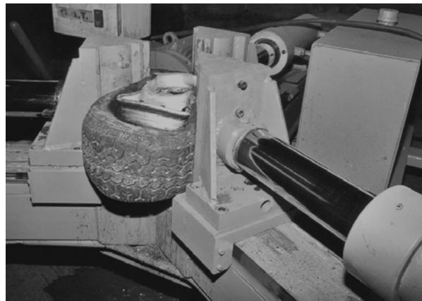
Abb.1-02: Felgenquetschmaschine: Linearführung mit Sonderschlitten der Baureihe GFW-4 Führungsschiene gehärtet und geschliffen, hydraulische Vorschubkraft 220 kN.
