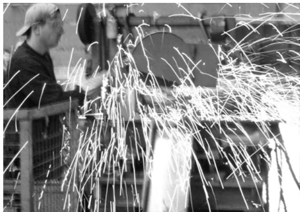
Abb.1-01: Trennschleifmaschine für Gusssteiger, Linearführung GFW-2-43-80 mit pneumatischem Vorschub, Trockenlauf
