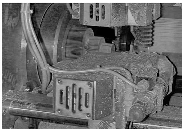
Abb.1-03: Fräsaggregat für Holzbearbeitungsmaschine: Linearführung GFW-2, Führungsschiene aus Niro-Stahl, Vorschubantrieb mit Servomotor – Trockenlauf.
