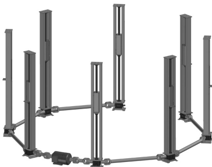
Hubvorrichtung Siloaufbau | Lifting device for silo assembly
